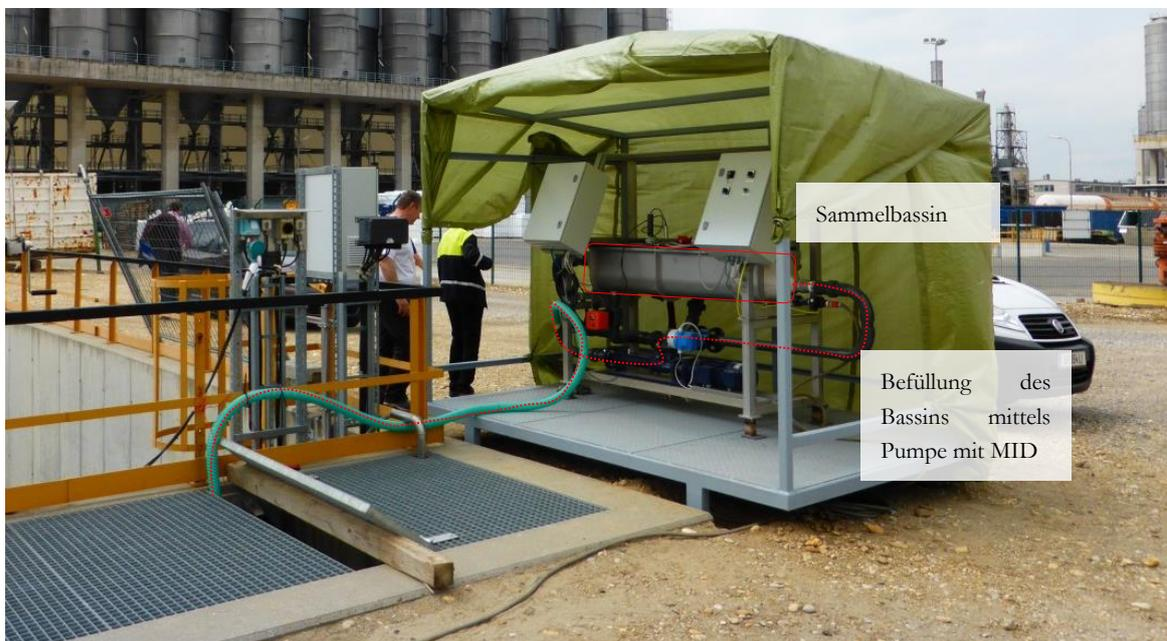
Abbildung 5: Bypass-Installation, seitlich befülltes Bassin (Quelle: TU Graz)
