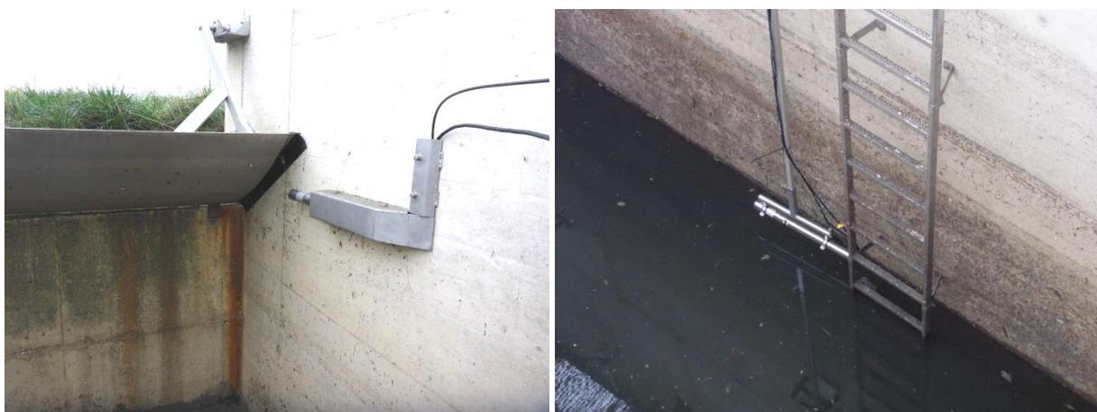
Abbildung 7: Installation an der Schwelle, links: feste Installation, rechts: klappbare Installation
