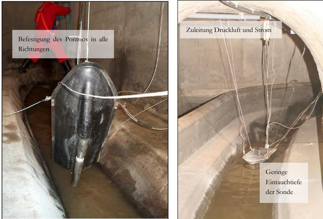
Abbildung 8: Schwimmende Installation (Quelle: TU Graz)
