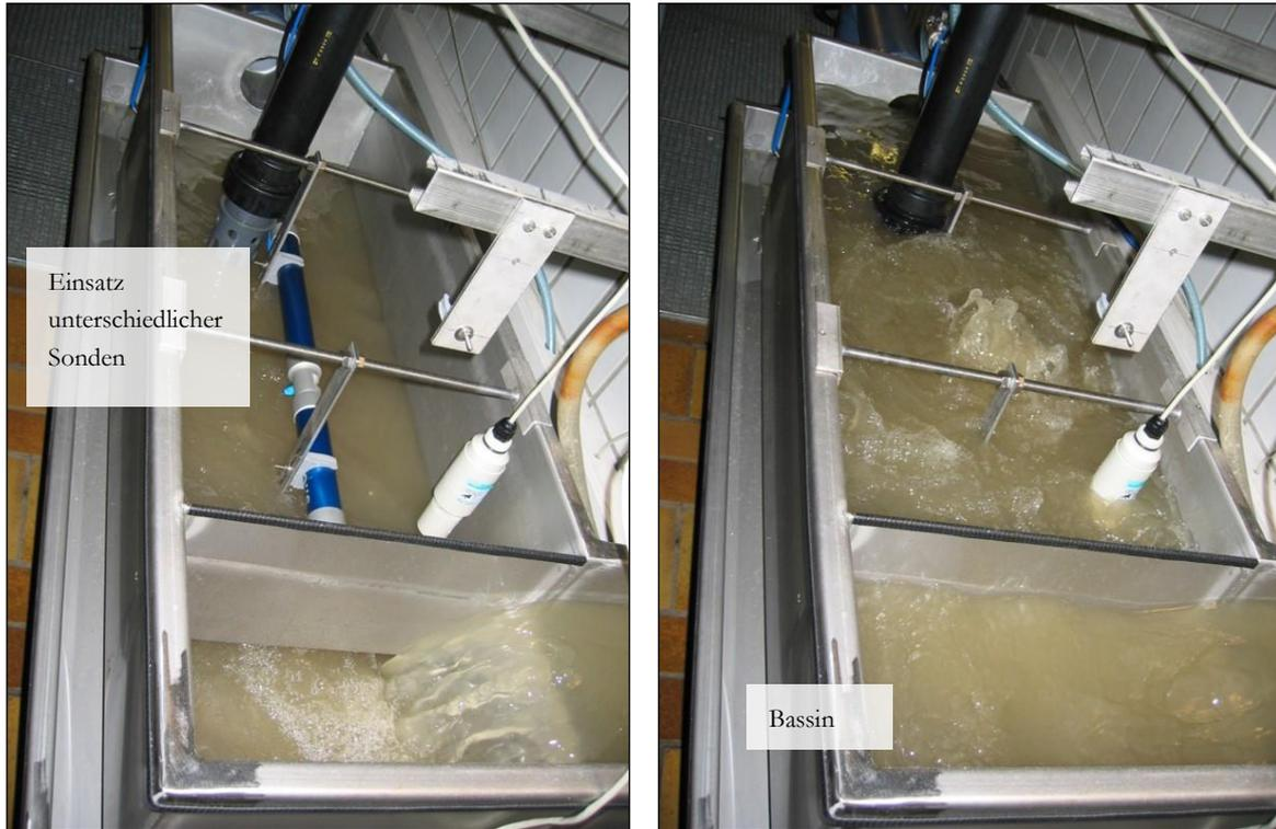
Abbildung 4: Bypass-Installation, von oben befülltes Bassin (Quelle: TU Graz)
