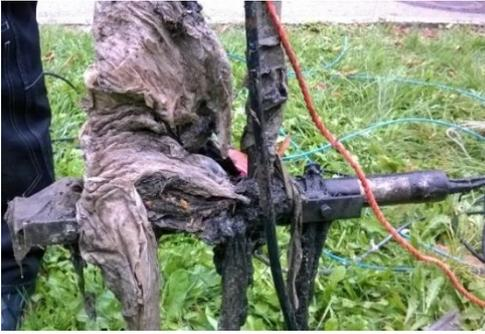
Zu dieser Zeit lieferte diese Sonde keine belastbaren Werte. Auch hier ermöglichte die Datenfernübertragung eine schnelle Erkennung und Behebung des Problems.
