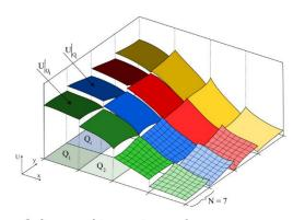
$$\frac{\partial}{\partial t} \int\limits_{E} J \vec{U} \phi \, d\vec{\xi} + \oint\limits_{\partial E} \left( \vec{\mathcal{F}}_{n}^{a*} - \vec{\mathcal{F}}_{n}^{v*} \right) \phi \, d\vec{s} - \int\limits_{E} \vec{\mathcal{F}}(\vec{U}, \vec{\nabla}_{x} \vec{U}) \cdot \vec{\nabla}_{\xi} \, \phi \, d\vec{\xi} = 0$$
