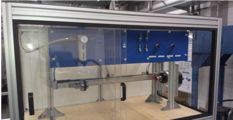
Abbildung 35: Testvorrichtung zur Durchführung von Funktions- und Dauertests.
