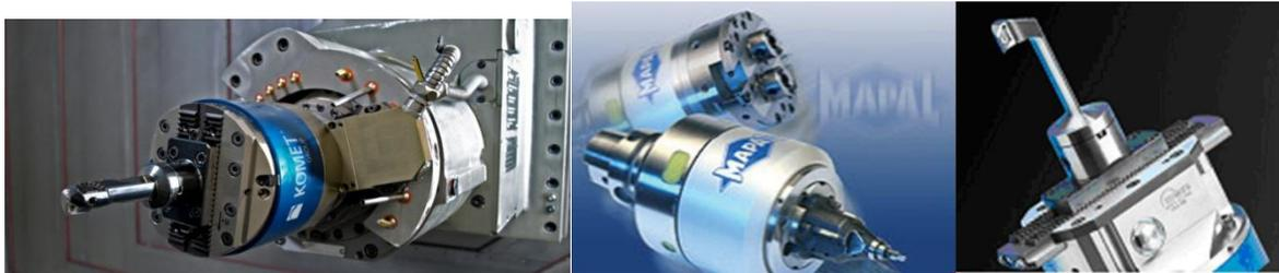
Abbildung 5: U-Achse mit Stator und Kabelintegration, U-Achs-Systeme (Quelle Mapal, KOMET)
