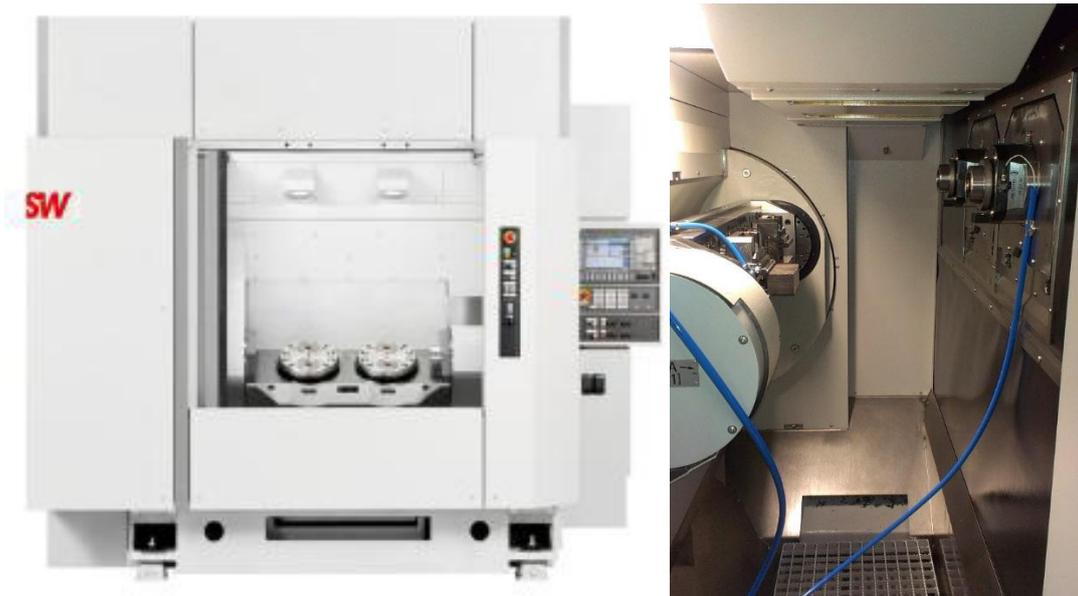
Abbildung 52: Demonstratormaschine Typ BA422 (links) mit applizierten Beschleunigungsaufnehmern im Bearbeitungsraum (rechts).
